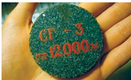
Фото 4. Образцы керна с глубины 12 км.
